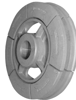
Stahlnabe STN mit Ausfallschlitz, besonders geeignet als Antriebs- und Umlenkrollen in Elevatoren zum Fördern von grobkörnigen Fördergütern; z.B.: Schotter, Steine, usw. Steel hub STN with cleaning slots, particularly suitable for driving and tail wheels in elevators for coarse-grained materials.
