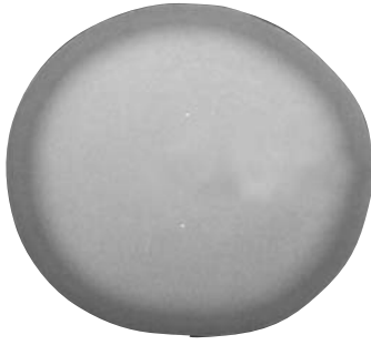
Querschliff in Rundungsmitte - Güteklasse G80E14 - Aufkohlungstiefe E14 = 0,14 x Kettendurchmesser Cross section at the interlink point of contact - quality grade G80E14 - carburizing depth E14 = 0,14 x chain dia.
